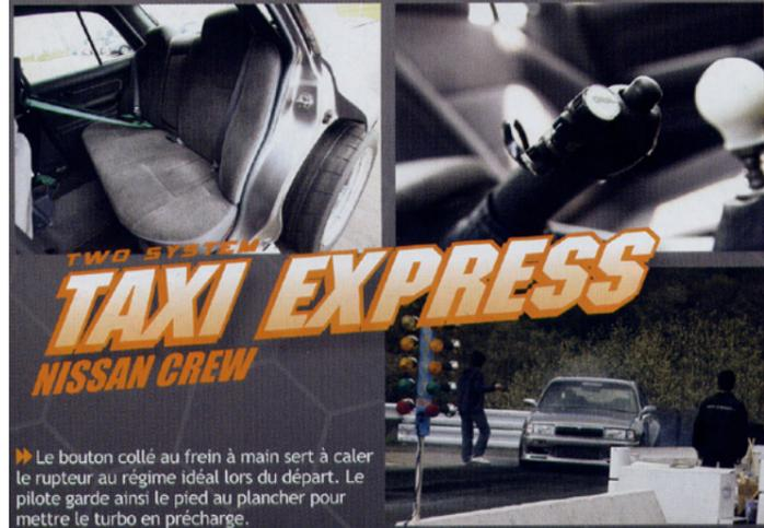
► Le bouton collé au frein à main sert à caler le rupteur au régime idéal lors du départ. Le pilote garde ainsi le pied au plancher pour mettre le turbo en précharge.
