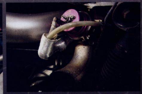
► Le séparateur Sard permet de retirer les bulles d'air emprisonnées dans le liquide de refroidissement et donc de conserver un échange thermique optimal.
